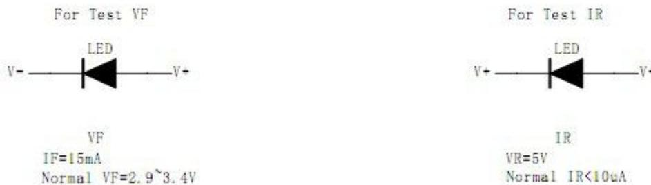
正向电压 VF 过高或反向电压 VR 过高，均会损坏 LED。
