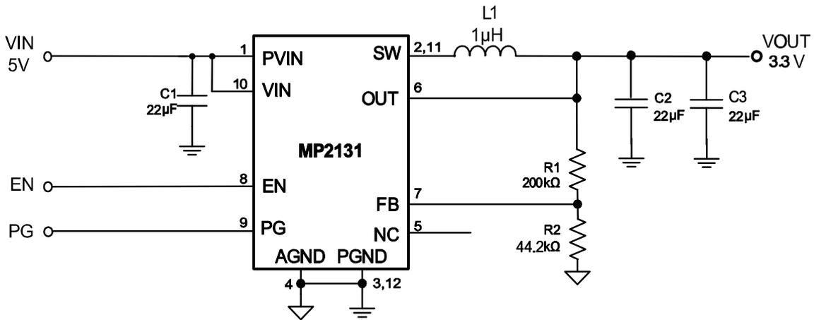
**Figure 7—5V<sub>IN</sub>, 3.3 V/4 A**
