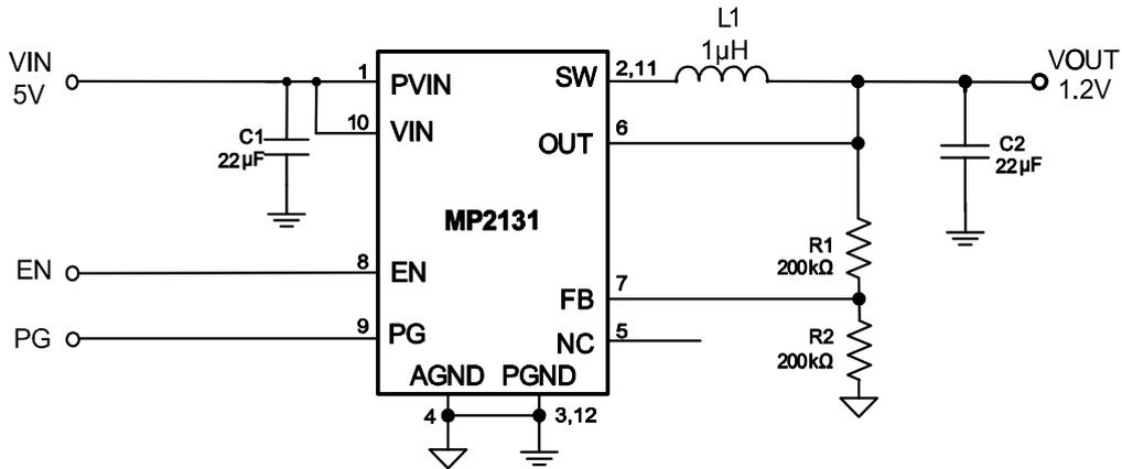
**Figure 6—5V<sub>IN</sub>, 1.2 V/4 A**
